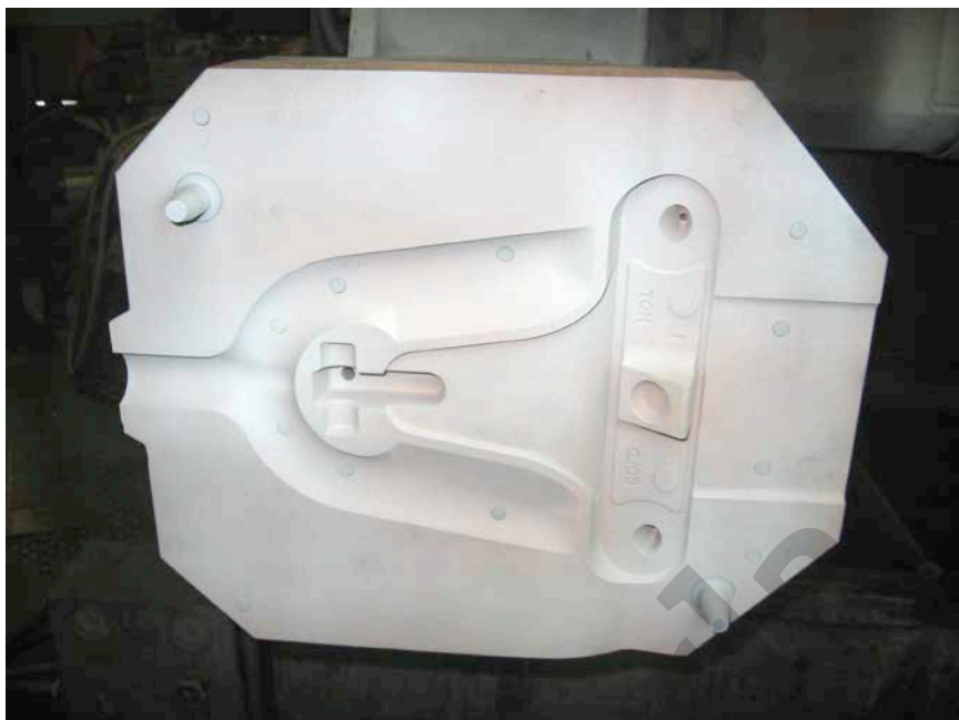
Bild 8: Die dünn beschichtete Form lässt das Formmaterial durchscheinen.
