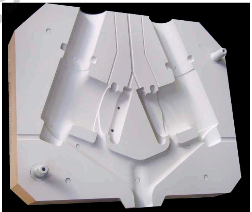
Bild 1: Kokille mit keramischer Beschichtung für die Herstellung von Messingussteilen.
