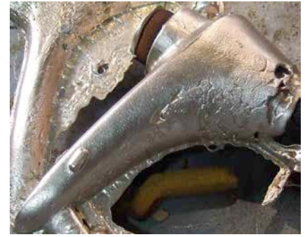
Bild 2: Feuchtefehler entstehen bei der Verwendung von Bindern, die bei Schmelzekontakt Restfeuchte abgeben.
