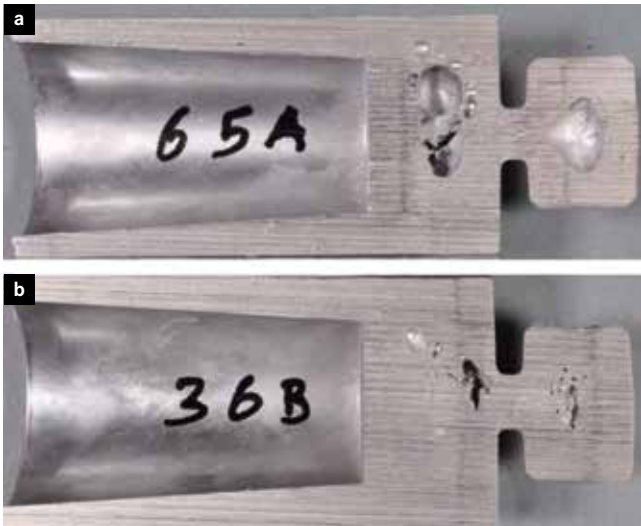
Bild 9: Schnitte durch zwei Probeteile, abgegossen bei unterschiedlichen Nachdrücken: a) 250 bar, b) 1000 bar.
