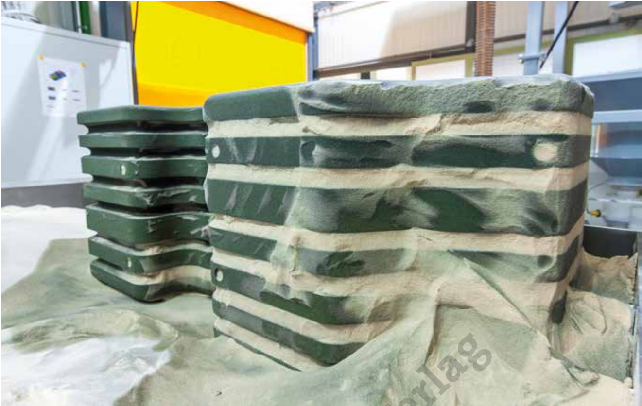
XXL-Kernpaket aus dem 3-D-Drucker von Christenguss in Bergdietikon, Schweiz.
