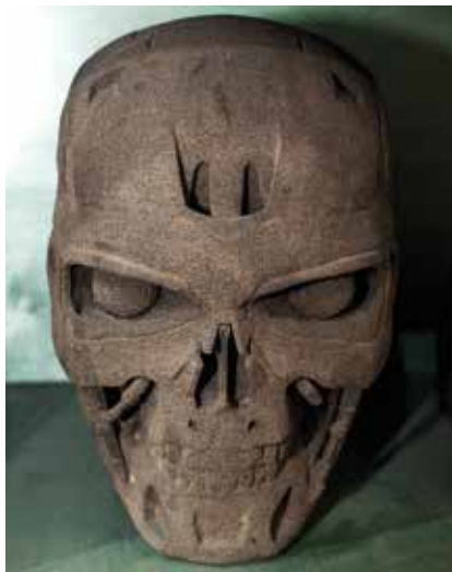
3-D-Drucker sind in der Lage, komplexeste Strukturen zu drucken, hier einen Totenkopf aus Formsand.
