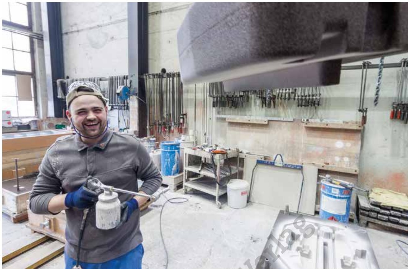
Ein Mitarbeiter sprüht einen Kern mit Trennmittel ein.
