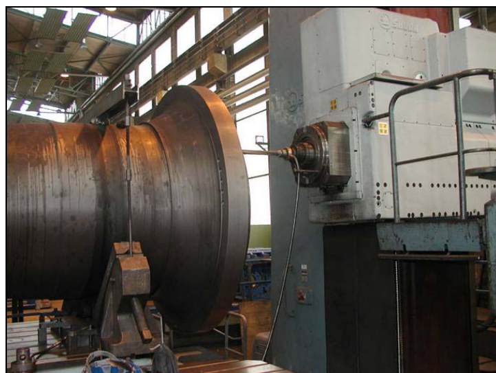
Bild 11: Die mechanische Bearbeitung der Rotorwelle
