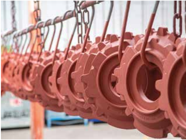
Grundierte Gussteile in Reih und Glied in der Putzerei. Hier ist eine umfangreiche Zu- und Abluftanlage installiert, für die rund zwei Millionen Euro investiert wurde.
