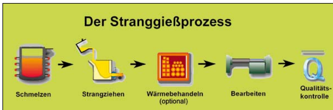
Bild 1: Ablauf des Stranggussprozesses (Foto: Gontermann-Peipers)
