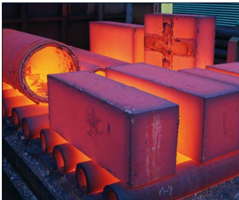
Bild 3: Blick in einen Wärmebehandlungssofen mit dem Kokillengusshalbzeug (Foto: Gontermann-Peipers, Siegen)
