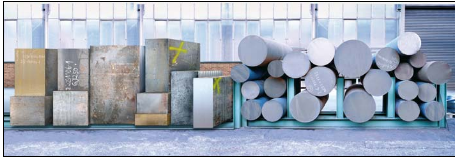
Bild 6: Schnelle Verfügbarkeit von Kokillengusshalbzeug verschiedener Abmessungen und Formen durch entsprechende Präventivlager in der Gießerei (Foto: Gontermann-Peipers, Siegen)
