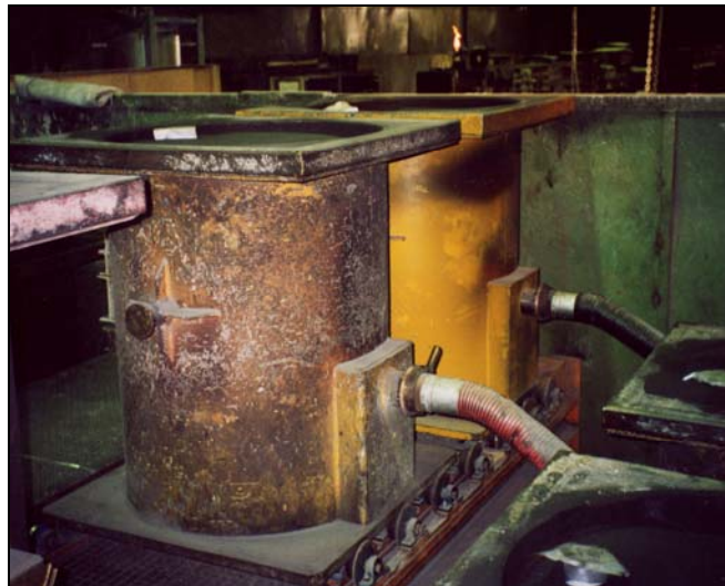
Gießbereite Formbehälter in der Gießstation einer Lost-Foam-Fertigung mit angelegtem Vakuum (Foto: LSG Gusstahl Lienen)
