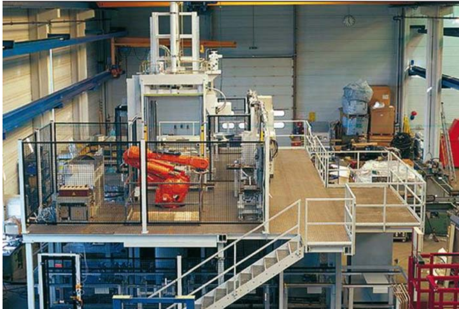
Bild 4: Eine für die prozesssichere Serienfertigung verkettete Niederdruck-Kokillengieß-Maschineneinheit, wie sie zur Herstellung von Motorblockgussteilen in Großserien zum Einsatz kommt (Foto: Kurtz, Kreuzwertheim)
