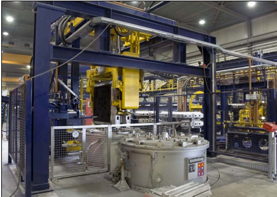
Eine Multi-Pouring-Niederdruck-Sandgieß-Formanlage (Bauart: Heinrich Wagner Sinto Maschinenbau GmbH, Bad Laapshe) (Foto: Eurotech Group)
