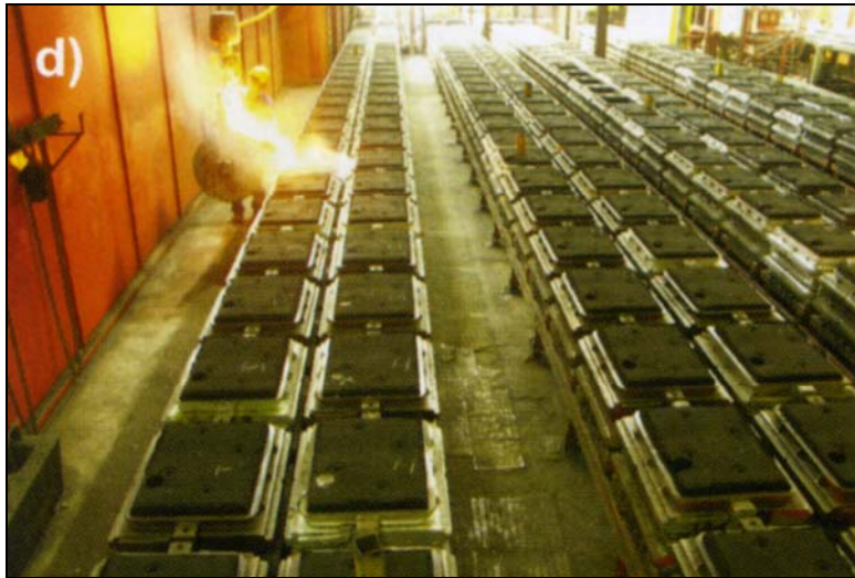
Bild 3: Großserienfertigung unter Nutzung von Sandformen auf automatischen Formanlagen (Foto: K.-H. Schütt)
