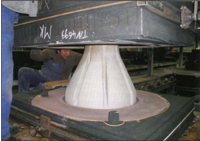
Bild 1: Mehrteilige kastengebunden gefertigte Sandform beim Zulegen eines Formteils (Das helle Teil in der Mitte ist ein stehender Kern für die Innenraumabformung des Gussteils) (Foto: Meuselwitzguss)
