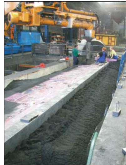
Bild 4: Herstellung einer Grubenform aus Kaltharzsand für ein sehr großes Gussteil (Foto: Meuselwitzguss)
